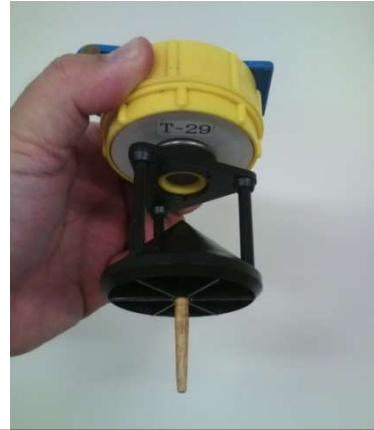
スプレッターの穴に棒を差し込んで、測量ポールの上部の穴に通す。
